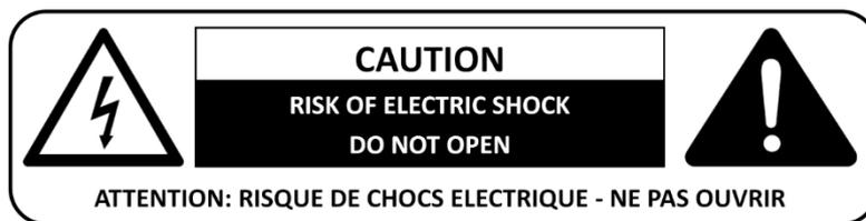
Per evitare il rischio di scosse elettriche, non aprire il dispositivo o l'alimentatore né rimuovere alcun coperchio. All'interno non sono presenti parti riparabili dall'utente. Rivolgersi esclusivamente a personale di assistenza qualificato per la manutenzione.
