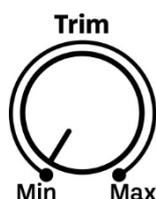
**Trim** — Il controllo Trim regola il livello dell'uscita delle cuffie da minimo (non completamente attenuato) a massimo.
