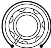
**Master** – Il controllo di livello Master regola il livello di uscita del bus Mix inviato alle uscite XLR Master e a qualsiasi sistema PA collegato.
