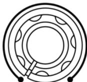
**Ritorno** – Il controllo Ritorno regola il livello del segnale di una sorgente esterna (ad esempio un processore di effetti) collegata alle prese Aux Return sul pannello posteriore.
