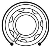
**Master** – Il controllo del livello master regola il livello di uscita del Mix bus inviato alle uscite XLR master e a qualsiasi sistema PA collegato.
