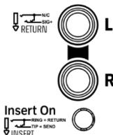
**Ritorno ausiliario / Insert** – Quando "Insert On" è disattivato, queste prese funzionano come ritorno ausiliario e seguono la convenzione standard Tip Hot, Ring Signal Ground and Sleeve Chassis Ground. Il livello di ingresso nominale è 0 dBu.
