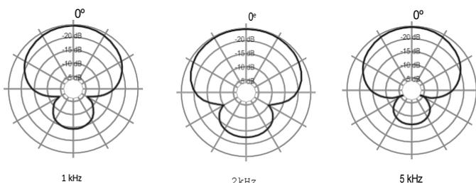
La curva di risposta in frequenza mostrata sopra (tolleranza di misura a +30B) e il diagramma polare corrispondono alle specifiche tipiche della produzione di questo microfono.
