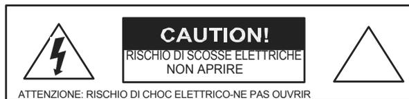
19. Il simbolo del fulmine con punta a freccia all'interno di un triangolo equilatero avverte l'utente della presenza di una "tensione pericolosa" non isolata all'interno dell'involucro del prodotto, che può essere di entità sufficiente a costituire un rischio di scossa elettrica.
